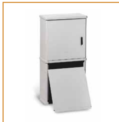
ASMC44 (9252040) Armadio stradale in vetroresina IP44 CEI EN 62208, IK 10 CEI EN 50102 RAL 7040. Con basamento h.550, dotato di serratura di sicurezza a cifratura unica. Dimensioni esterne: 546x308x1110h - interne: 515x260x543h Outdoor SMC (fiberglass-reinforced plastic) cabinet IP44 CEI EN 62208 IK 10 CEI EN 50102 RAL 7040. With base 550H. Equipped with security lock. External dimensions: 546x308x1110h - internal: 515x260x543h
