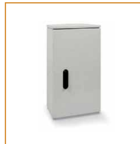
ASMC55 (9252050) Armadio stradale in vetroresina IP55 CEI EN 60529, 20J resistenza impatto RAL 7035. Autoestinguente, resistenza alle fiamme V0- UL94. Dotato di serratura di sicurezza a cifratura unica. Con telaio e piastra di fondo. Dimensioni esterne: 465x320x855h - interne: 430x260x765h Outdoor SMC (fiberglass-reinforced plastic) cabinet IP55 CEI EN 60529, 20J impact resistance, color RAL 7035. Flame retardant V0-UL94. Equipped with security lock, frame and foundation base. External dimensions: 465x320x855h - internal: 430x260x765h
