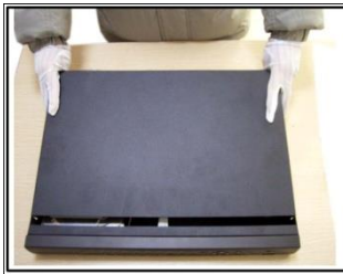
2. ábra Tető leemelése
